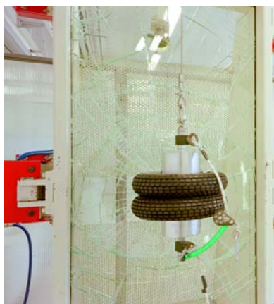
Figura D.1 - Provino intelaiato rotto
