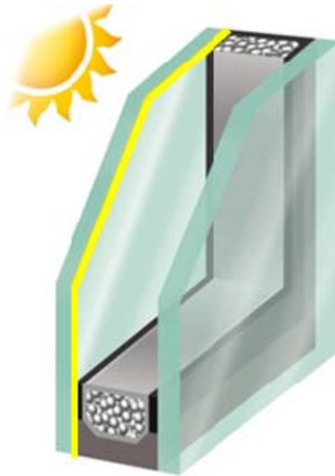
Figura 5 – Schema di vetrata isolante con coating in faccia 2
