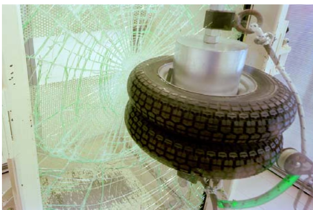
Figura D.2 - Provino intelaiato rotto: particolare
