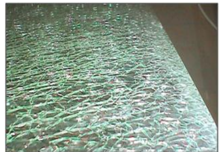
c) rottura di una lastra stratificata di sicurezza, con vetri temprati
